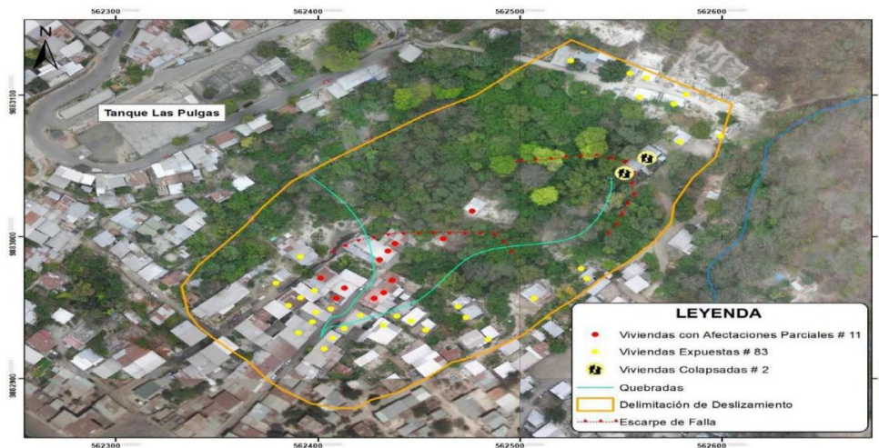
Map3. Delimitación de la zona de riesgo por deslizamiento de la ciudadela El Fátima
